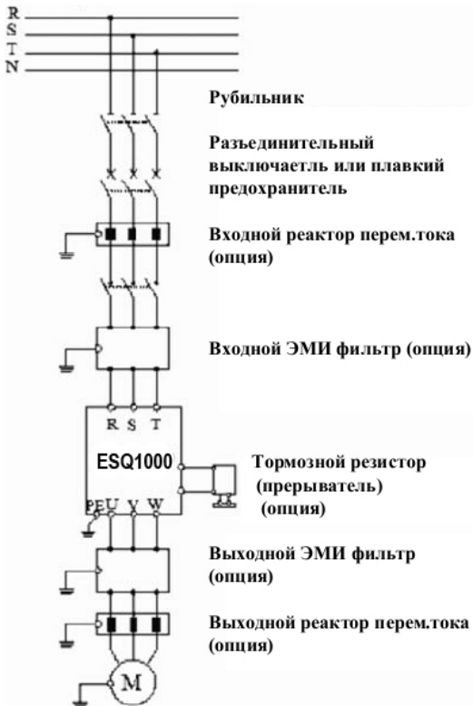
Рис. 3-8 Соединение инвертора и присоединяемых частей
