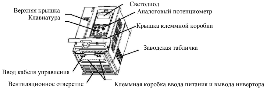
Рис. 2-3-а Рисунок с наименованиями частей инвертора ESQ1000-2S0004-ESQ1000-4T0110P
