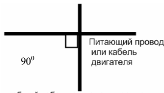
Рис. 3-20 Требования к прокладке проводов в системе
