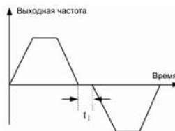
Рис.6-9 Время участка бездействия FWD REV
