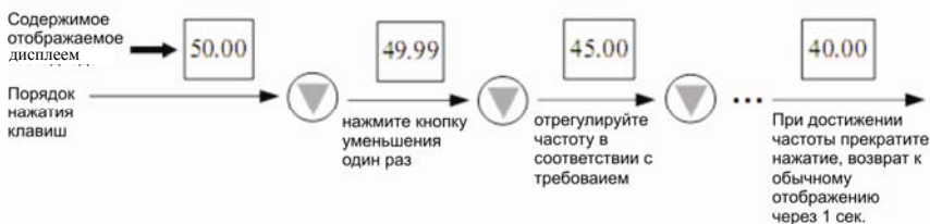
Рис. 4-8 Пример регулировки установленной частоты
