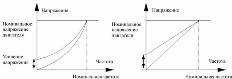
(a) график усиления вращающего момента, кривая замедления вращающего момента (b) график усиления вращающего момента, кривая постоянного вращающего момента
