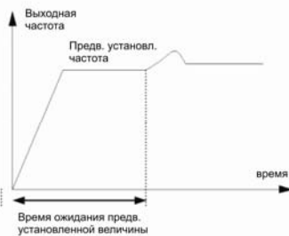
Рис. 6-18 предварительно установленная частота замкнутого контура
