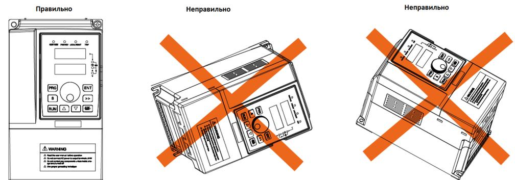
Рис.3-1 Положение при установке
