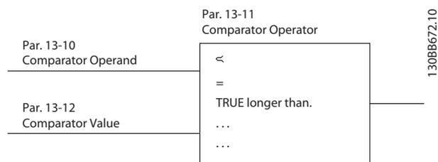
Кроме того, имеются цифровые величины, сравниваемые с фиксированными значениями времени. См. объяснение в 13-10 Comparator Operand. Компараторы выполняют сравнение один раз в каждом интервале контроля. Результат сравнения (TRUE или FALSE) используется непосредственно. Все параметры в данной группе являются параметрами типа массива с индексами от 0 до 5. Выберите индекс 0 для программирования компаратора 0, индекс 1 для программирования компаратора 1 и т.д.
