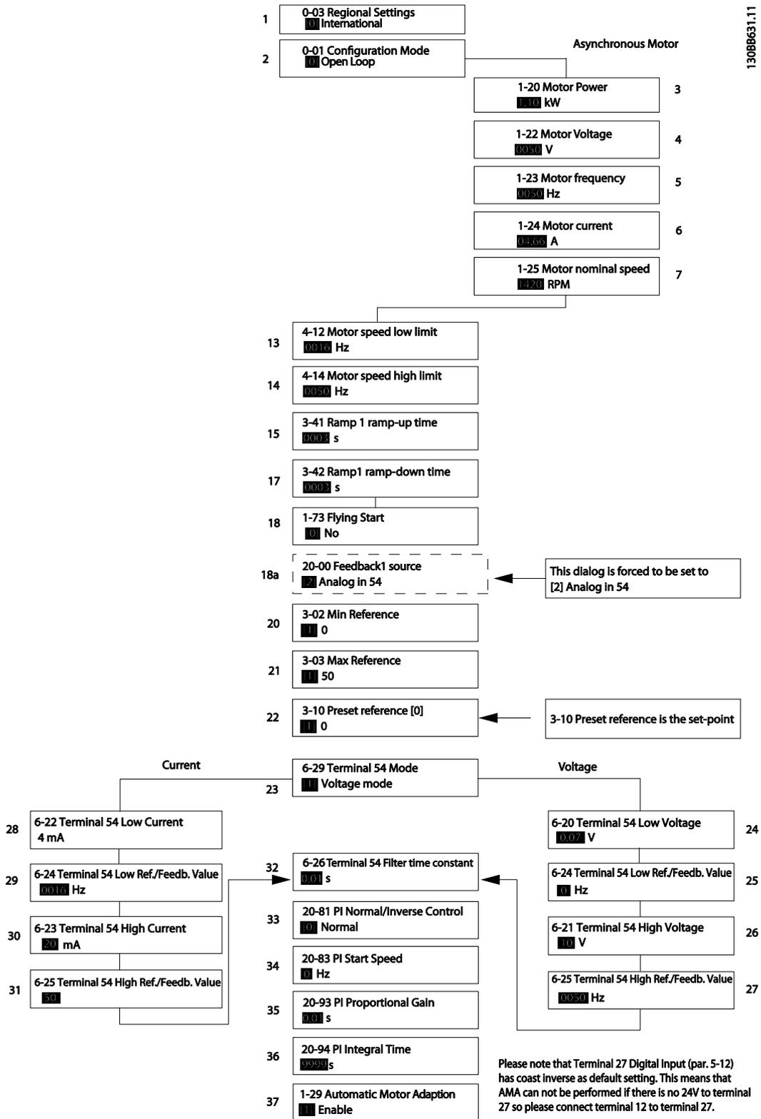
**Closed Loop Set-up Wizard (Мастер настройки параметров замкнутого контура)**
