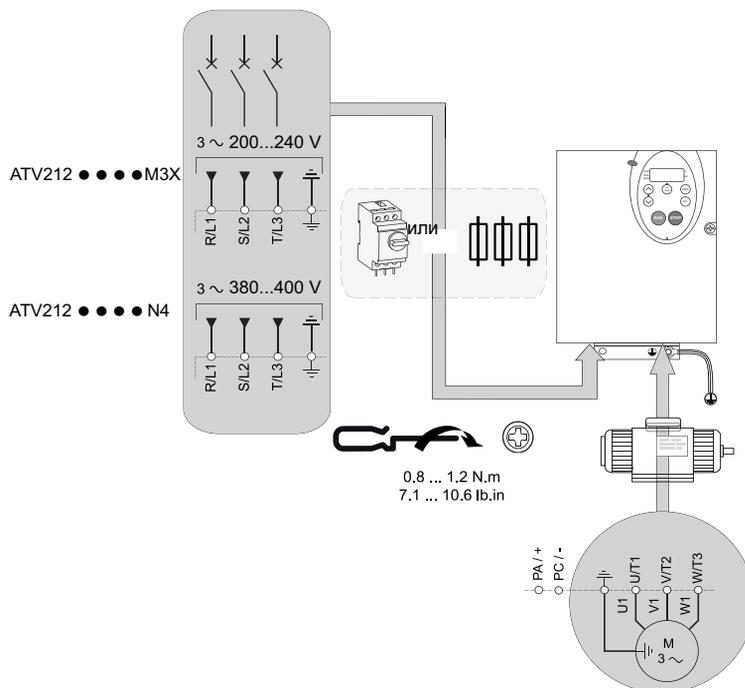
**Примечание:** у ПЧ ATV212H075●●●, ATV212HU15●●●, ATV212HU22●●●, для подключения питания оторвите крышку, снимите коммуникационный модуль, подключите R/L1, S/L2, T/L3 и поставьте на место коммуникационный модуль.
