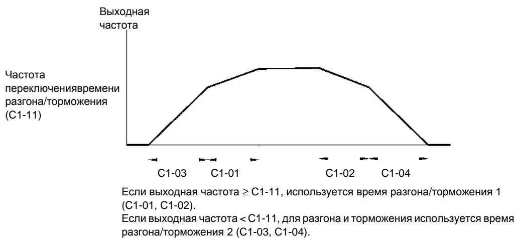
Рис. 6.18 Переключение времени разгона/торможения по частоте
