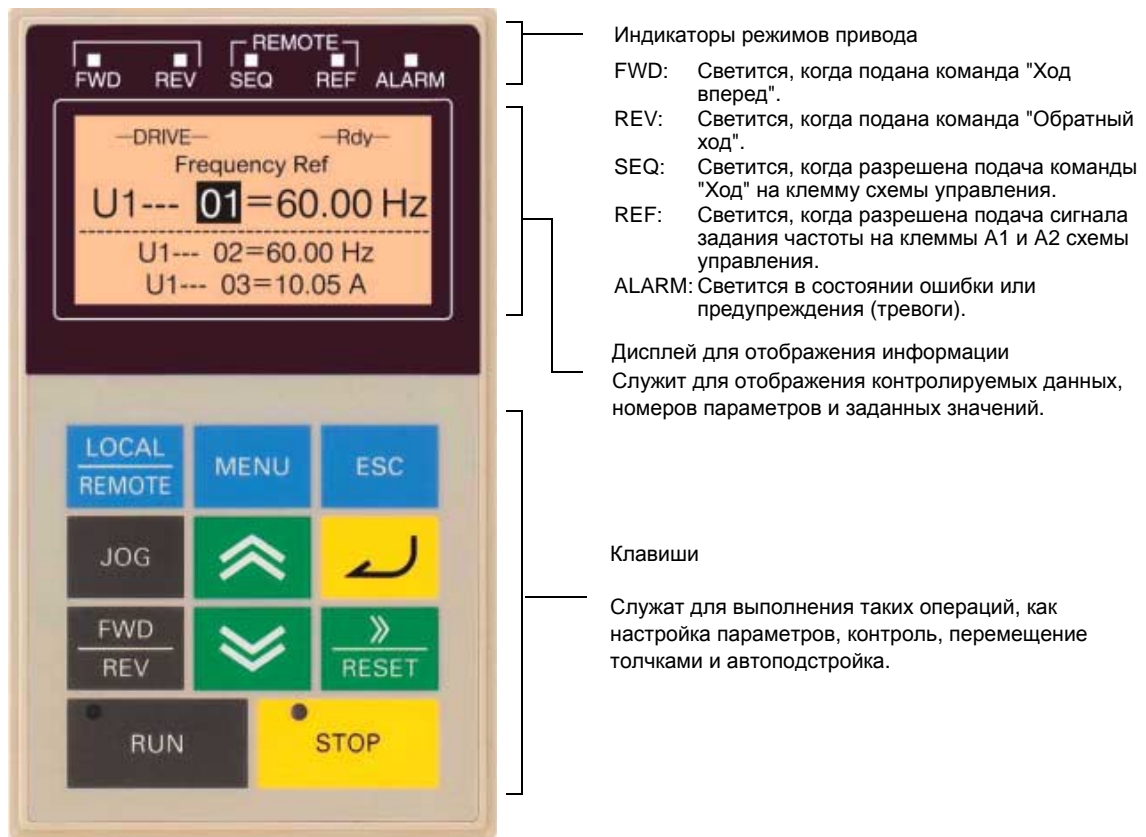
Рис. 3.2 Названия и функции элементов цифровой панели управления с ЖК-дисплеем
