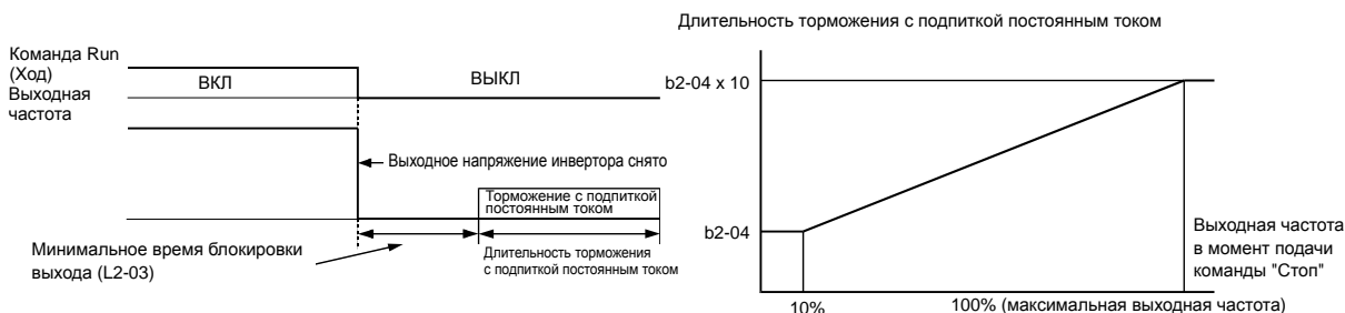
Рис. 6.16 Торможение с подпиткой постоянным током
