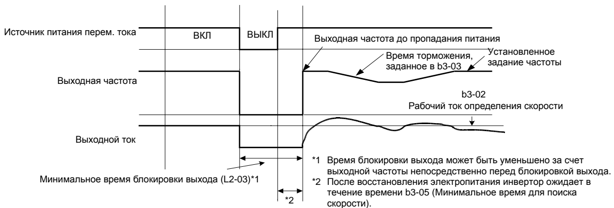
Рис. 6.36 Поиск скорости после блокировки выхода (определение тока; время пропадания < L2-03)
